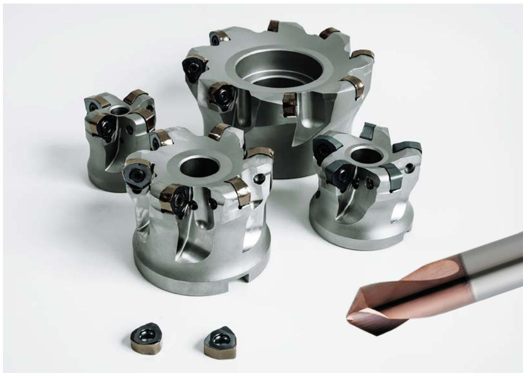
Utensili Moldino serie TD6N a fissaggio meccanico con inserto a 6 taglienti (particolarmente indicati per alti volumi di sgrossatura su stampi di grandi dimensioni e su materiali fino a 50 HRC), insieme al DN2HC, utensile specifico per la realizzazione di smussi su acciai temprati
